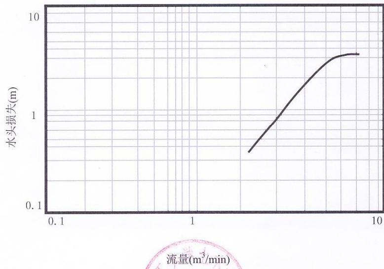
图2 水泵底阀流量—水头损失关系曲线(对数坐标)
